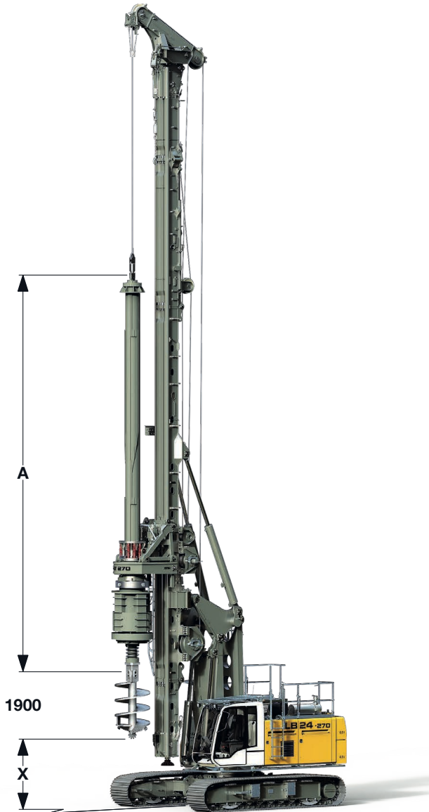
LB 24-270 mit Zusatzausrüstung und automatischem Druckrohr
